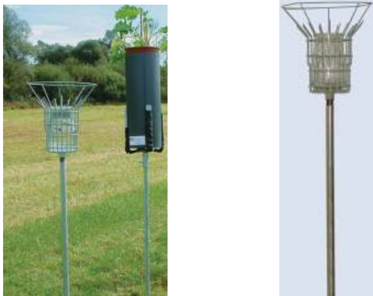
Slika 1. i 2. Izgled sedimentatora po Bergerhoff –u [6]
