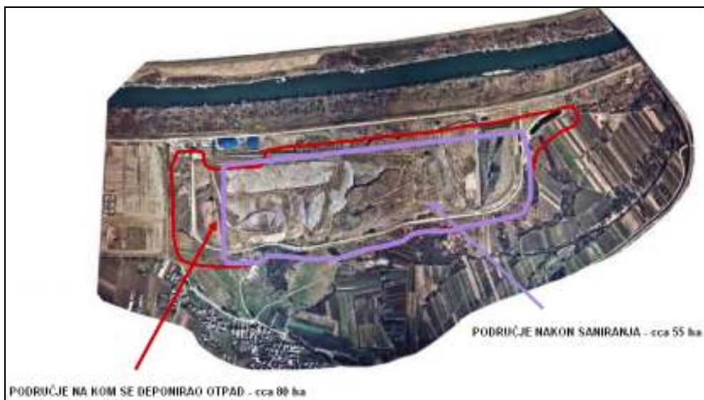
Slika 4. Smanjenje odlagališne površine za 25 ha nakon sanacije
